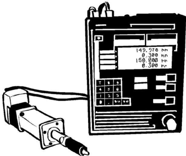
製品マスターをノギス、マイクロ、三次元測定器等で計測します。
